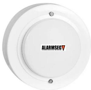
Seu funcionamento é baseado na detecção de temperatura, ativando um alarme quando o sensor atinge 57 °C, sinalizando um possível princípio de incêndio. Assim que o alarme é acionado, a central de detecção ativa todos os dispositivos de saída, como sirenes, garantindo uma evacuação rápida e segura.
